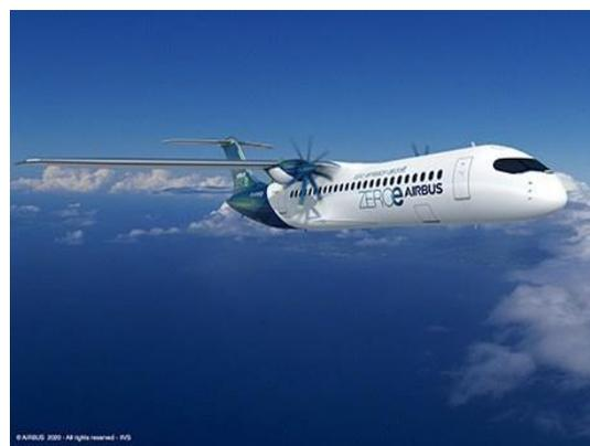
エアバス社のターボプロップデザインは最大100席の設置が可能で、改良したガスタービンエンジンで水素を燃焼させる。写真提供 エアバス 2020 不許複製
