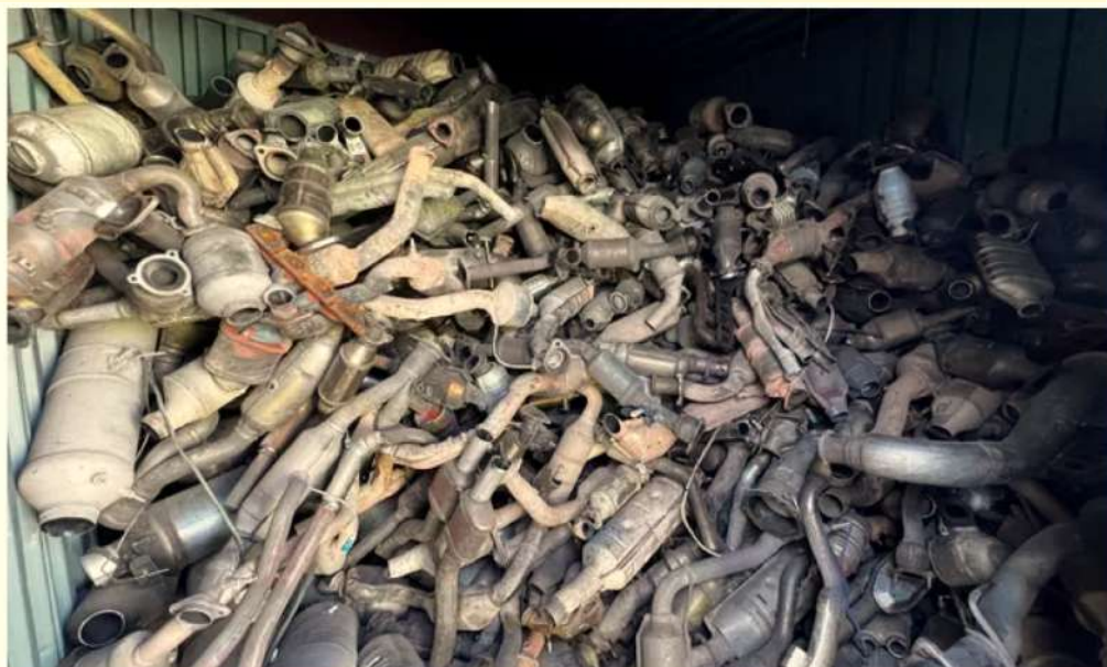
自動車触媒装置は有害排気ガスを安全なものに転換する装置
